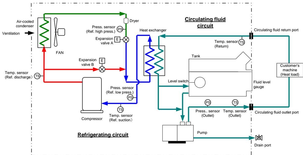
Fig. 9-3 Flow diagram(HRS090-A\*-20/40\*)
